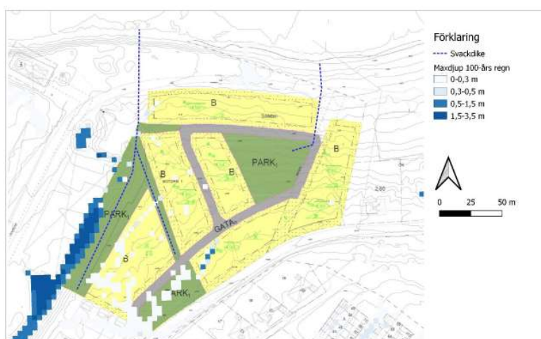
Figur 41. Bilden visar maxdjup vid 100-års regn baserat på Härnösands kommuns skyfallskartering med föreslagen placering av svackdiken.
