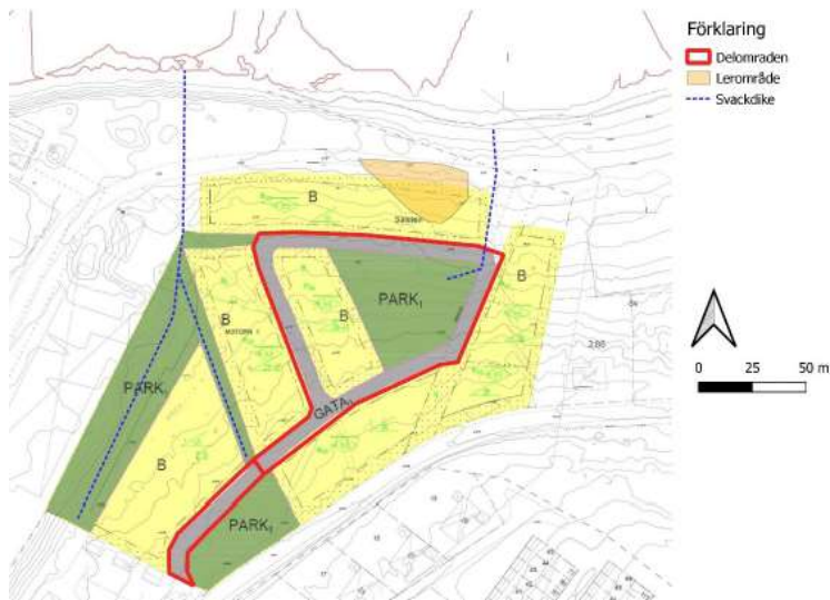
Figur 40. Skiss över hantering av dagvatten från hårdgjorda ytor.
