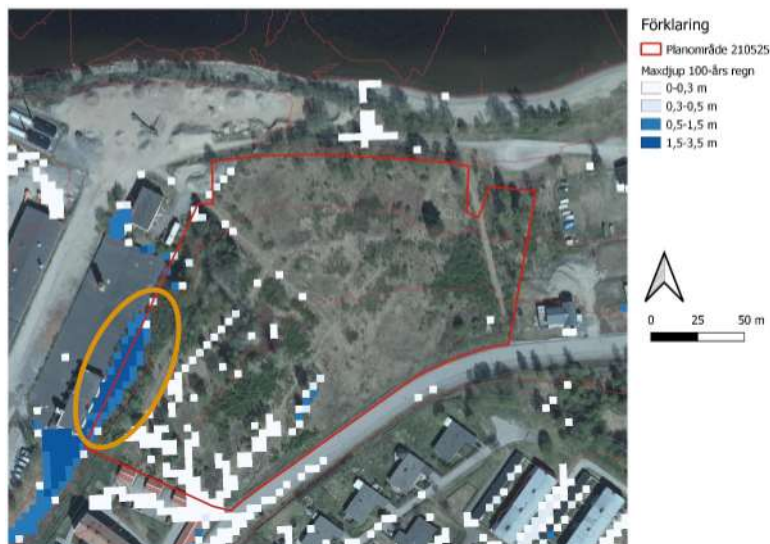
Figur 21. Resultat från skyfallskarteringen. Orange markering visar lågpunkten i området sydvästra del. Structor Norr AB
