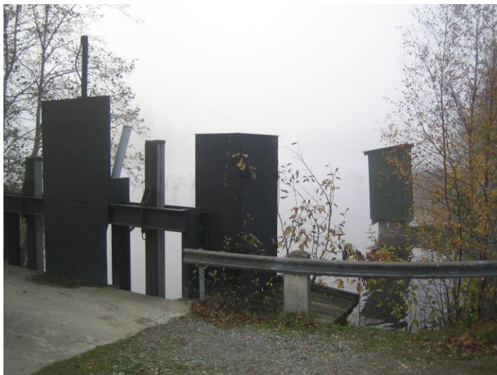
På norra stranden ovan dammen är en automatiskt avläst pegel
