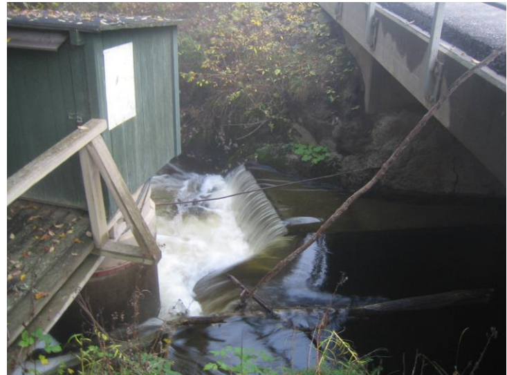
En bit nedanför dammen mäts vattenföringen över ett fast skibord
