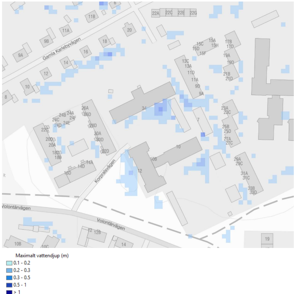
Figur 55. Skyfallskartering som visar maxdjup vid ett 100 årsregn. Skyfallet är beräknat med en klimatkfaktor på 1,25.
