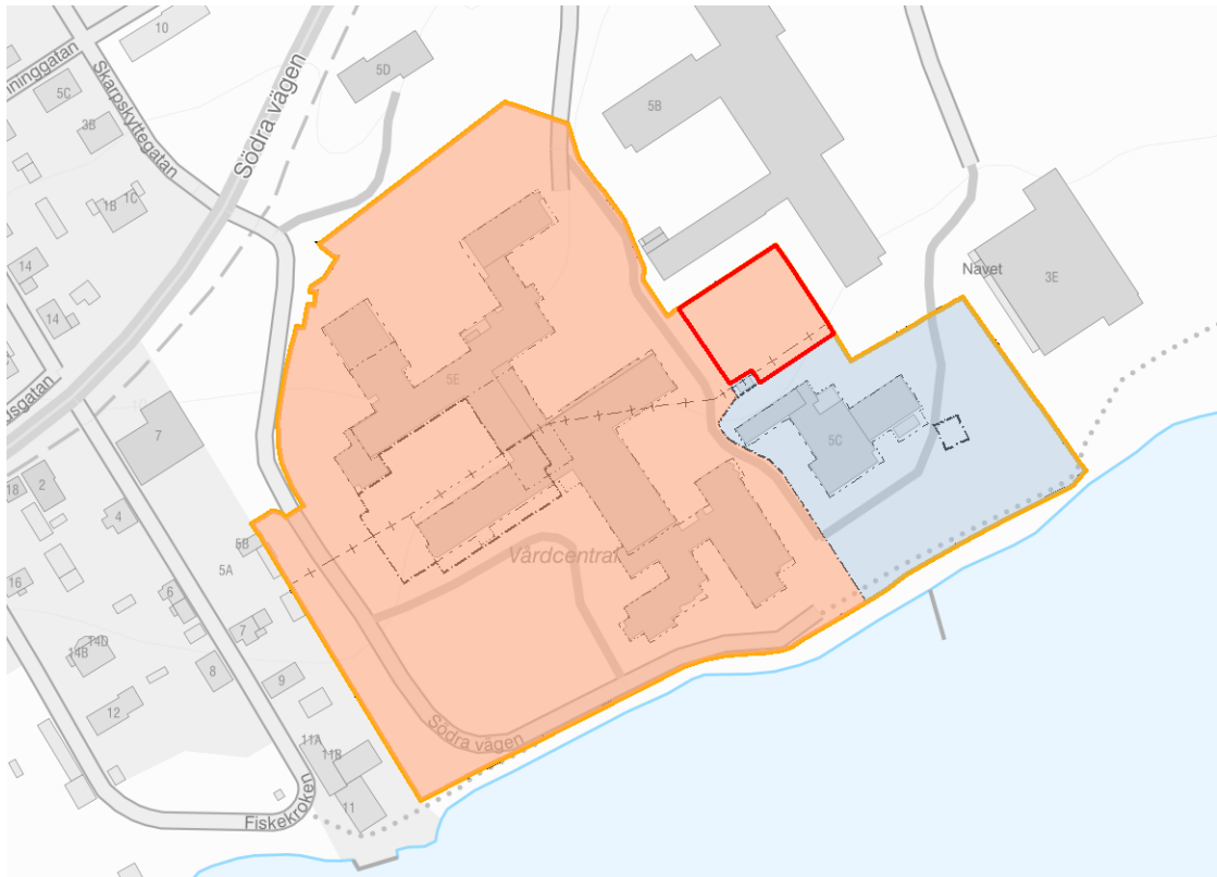
Figur 11. Egenskapsbestämelsen marken får endast förses med garage, carport och markparkering illustreras (rött avgränsat område).
