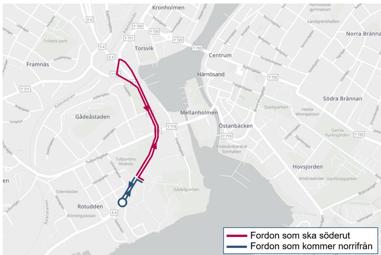
Bild 22. Karta över körsträckor för fordon som ska söderut samt fordon som kommer norrifrån vid mittrefug som endast tillåter högersvängar i korsningen E4/infarten till SIDA.
