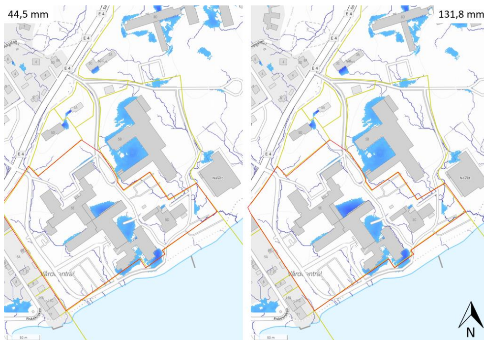
Figur 6. Grad av översvämmat yta (blå) inom planområdet (röd) vid 100-årsregn med olika varaktigheter samt ett 1000-årsregn (Scalgo Live, 2023).
