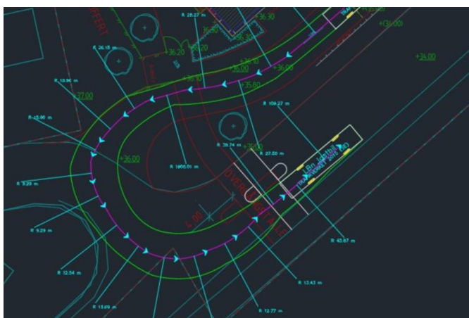
Figur 7 - Körspår för tunga fordon österut korsning Bergstigen/Sockenvägen
