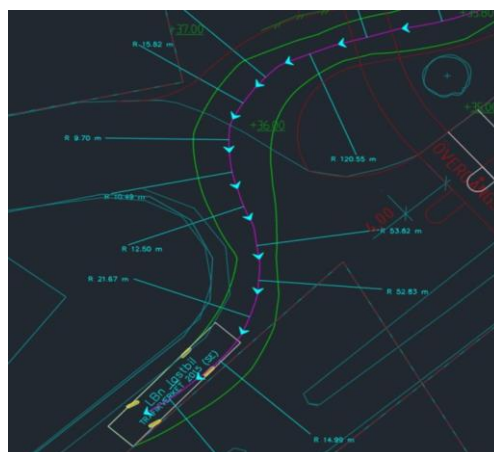
Figur 8 - Körspår för tunga fordon västerut korsning Bergstigen/Sockenvägen
