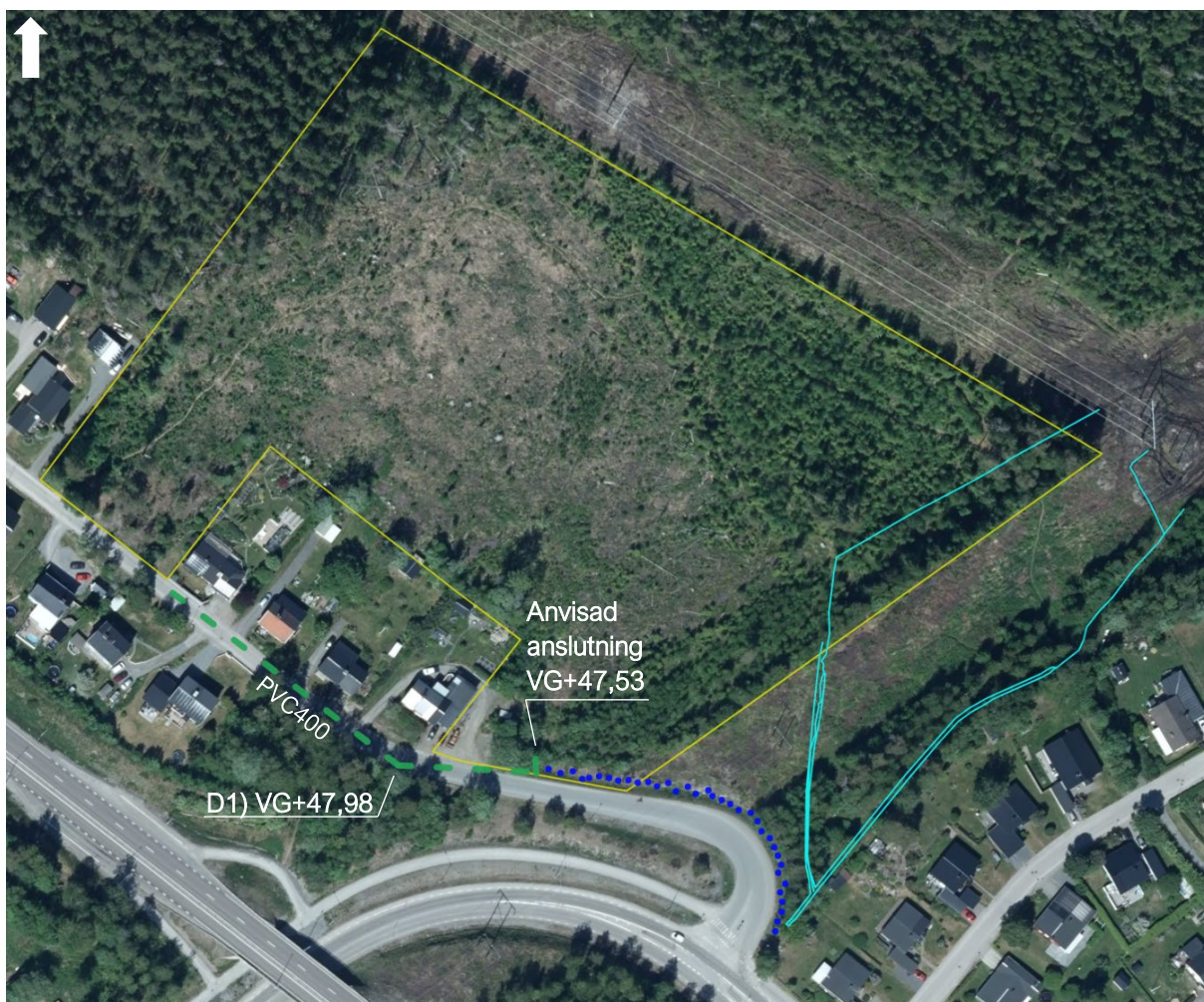
Figur 5. Anvisad dagvattenanslutning utifrån VA-underlag, WSP 2024-10-07
