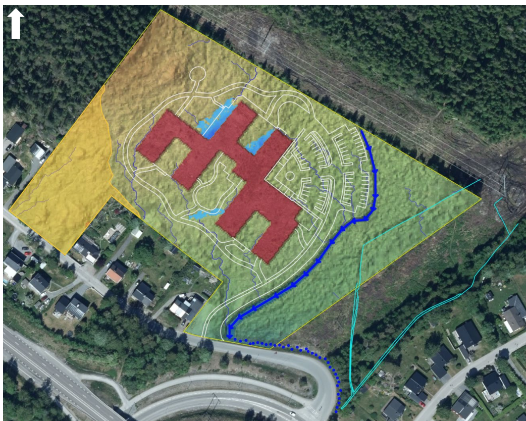
Figur 9. Stående vatten vid skyfall illustreras med blå markering om inte avskärande dike anläggs
