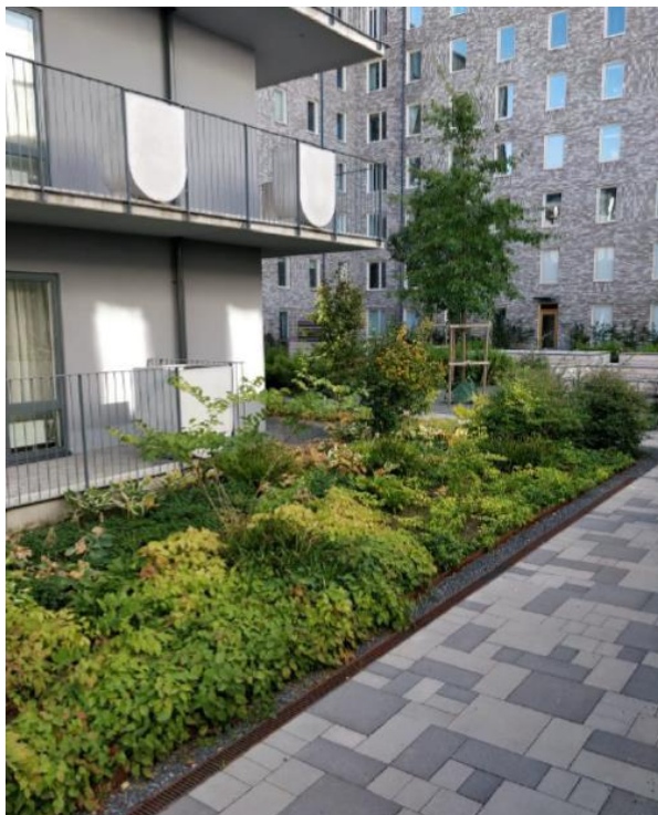
Figur 23. Exempel på biofilter/raingardens i anslutning till flerbostadshus. Foto: Sweco.
