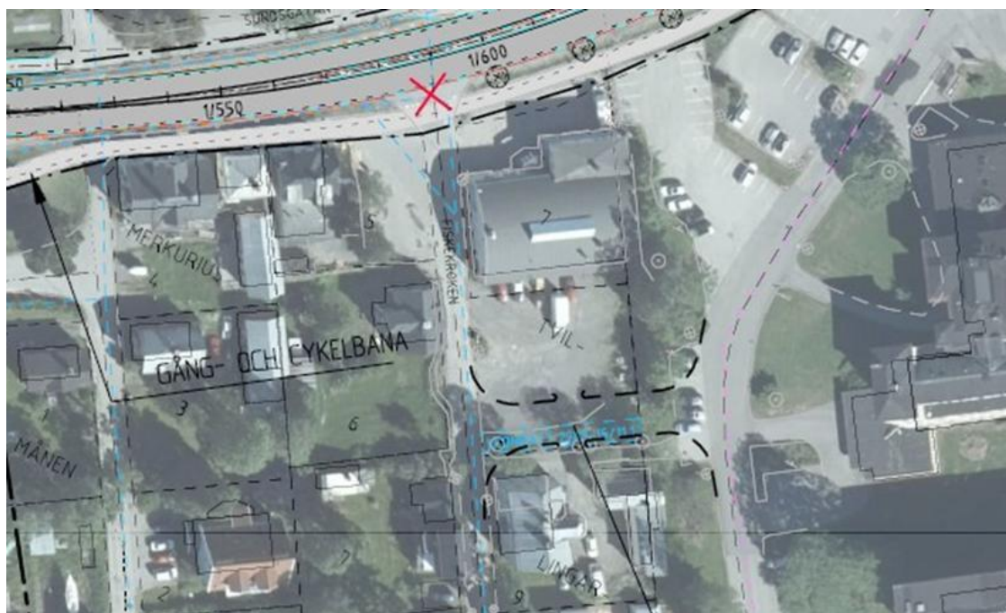
Figur 22. Utdrag från Trafikverkets illustrationskarta nummer 4 som illustrerar stängningen av infarten och lokaliseringen av ny ersättningsväg.
