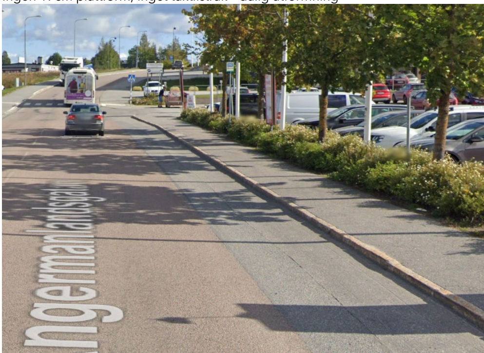
Industrigränd Örnsköldsvik - 56 påstigande per dygn 2019 (hållplatsklass B) Ingen 17cm plattform, inget taktilstråk - dålig utformning
